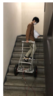
図3 人と協調する階段昇降移動ロボット
